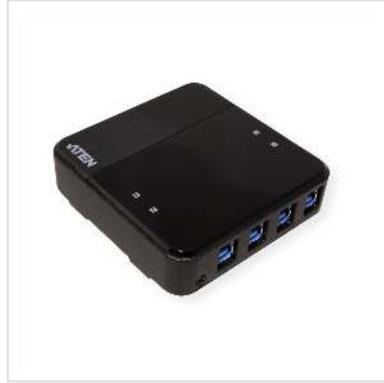
**Der ATEN US3344 ist ein 4-Port USB 3.1 Gen1 Peripherie-Freigabegerät, das es Benutzern ermöglicht, vier USB-Geräte mit Hilfe von USB 3.1 Gen 1-Typ-B auf Typ-A Kabeln zwischen 4 verschiedenen Computern zu teilen.**
