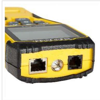
**Vielseitiger Kabeltester für Sprach-, Daten- und Videosysteme, der Koaxial-, Daten- und Telefonkabel ortet und überprüft. Mit den mitgelieferten Remote-Einheiten identifizieren Sie mehrere Kabelverläufe gleichzeitig. Dieses Kit sorgt jederzeit für genaue Kabelinstallationen.**
