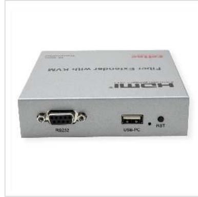
**Die KVM-Verlängerung überträgt HD-Audio- und Videosignale sowie USB-Signale bis zu 20 km weit über bidirektionales LWL-Einzelfaserkabel. Damit kann ein Computer-System in bis zu 20 km Entfernung von der Remote-Konsole aus (HDMI 4K-Monitor, USB-Tastatur und USB-Maus) gesteuert werden.**
