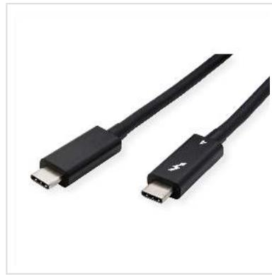
**Thunderbolt™ 4 Kabel mit dem von USB 3.1 bekannten Typ C Stecker bieten Ihnen die momentan höchstmögliche Datenübertragungsrate von bis zu 40 Gbit/s und volle Stromversorgungs-Unterstützung (bis 20V 5A / 100W)! Die Kabel verfügen außerdem über den DP Mode für besonders hochauflösende Bild- und Tonübertragung von bis zu 7680x4320 @60Hz (8K).**
