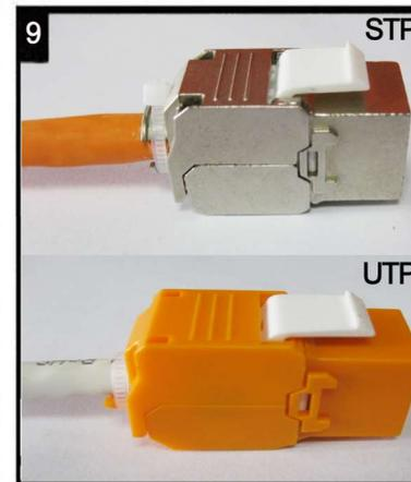
9 Das Modul mit dem Kabelbinder zugentasten und die Schirmschelle fixieren.
