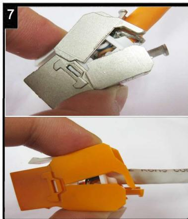
7 Die Montageklappen schließen -mit diesem Vorgang wird das Modul kontaktiert.
