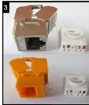
3 Der Kabelsortierer verfügt über beide Farbcodes(568A/B).Wählen Sie den entsprechenden Farbcode.
