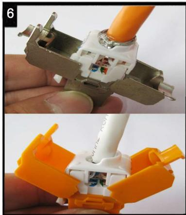
6 Den Sortierer in Pfeilrichtung in das Modul einsetzen.Bitte Pfeilrichtung beachten!
