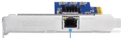
RJ-45 Ethernet-Port (unterstützte Geschwindigkeiten: 2,5Gbps / 1Gbps / 100Mbps)
