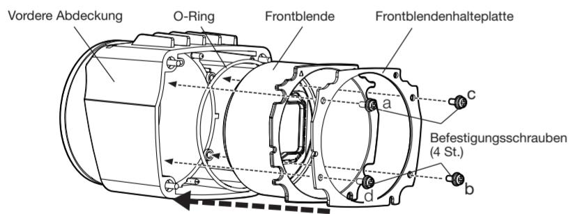
**Schritt 4****Wiederanbringen der vorderen Abdeckung am Kameragehäuse**
