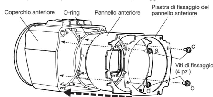
**Passaggio 4****Instale nuevamente el coperchio anteriore sul cuerpo de la cámara.**
