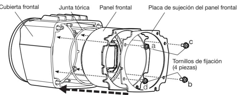
**Paso 4****Coloque la cubierta frontal de nuevo en el cuerpo de la cámara**
