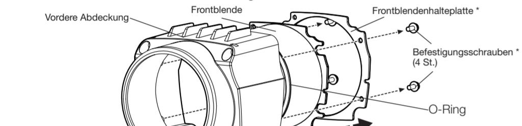
\* Die entfernte Frontblendenhalteplatte und Befestigungsschrauben (4 St.) aufbewahren, bis Sie sie im Schritt 3 verwenden.
