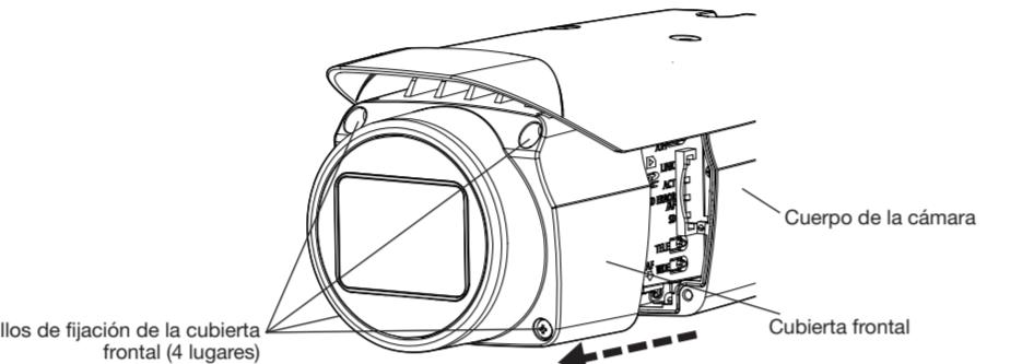
**Paso 2****Extraiga el panel frontal de la cubierta frontal.**
