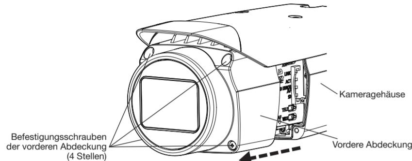
**Schritt 2****Die Frontblende von der vorderen Abdeckung entfernen.**
