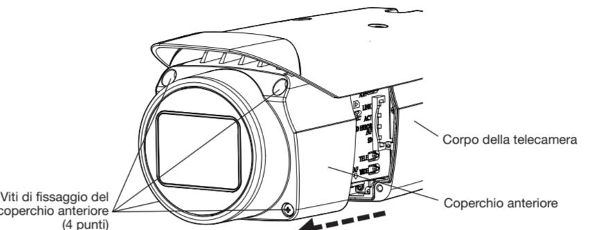
**Passaggio 2****Rimuovere il pannello anteriore dal coperchio anteriore.**
