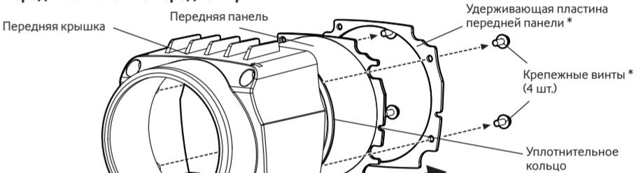
\* Положите снятую удерживающую пластину передней панели и крепежные винты (4 шт.). Они пригодятся при выполнении шага 3.
