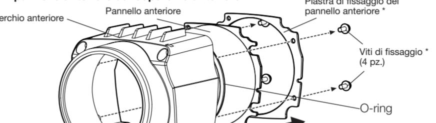
**Passaggio 3****Sostituzione del pannello anteriore**
