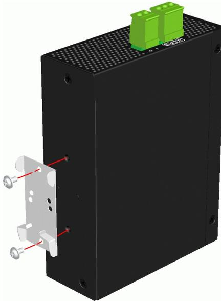
2. Setzen Sie die Halterung an der Unterkante der Hutschiene an und drücken Sie das Gerät etwas nach oben, bis die Halterung an der Oberkante der Hutschiene einrasten kann.
