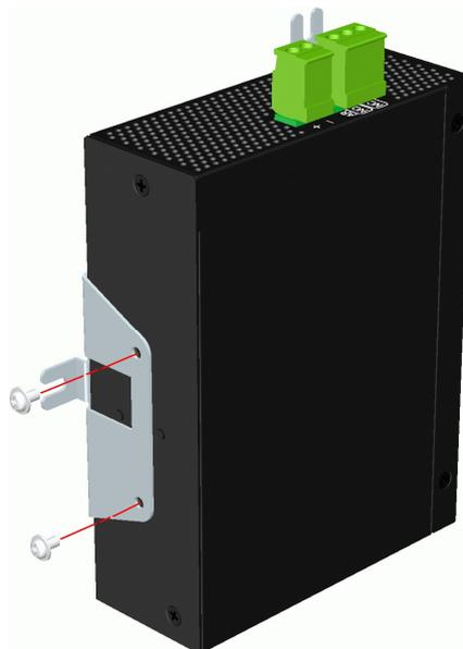
3. Schrauben Sie den Switch auf eine Platte. Die Positionen der Schrauben werden unten angezeigt:
