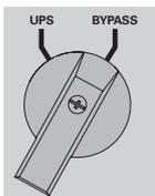
1. Versetzen Sie die USV in den „**internen Bypass-Modus**“ (siehe das Benutzerhandbuch der USV)
