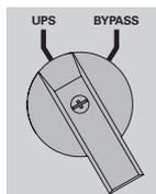
12. Setzen Sie den manuellen Bypass-Schalter am MBP auf die Stellung **„UPS“**: Die **rote Leuchte „Bypass-Modus“** am MBP verlöscht und zeigt damit an, dass die Last jetzt von der USV versorgt wird
