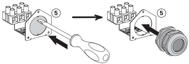
3. Führen Sie ein Stromkabel (Querschnitt siehe Abschnitt 3.5) durch die Kabelverschraubung der MBP Bypass Input Abdeckung (5) (Kabel nicht im Lieferumfang).
