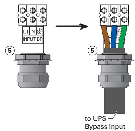
7. Schließen Sie die 2 integrierten Stromkabel (1) und das zuvor installierte Bypass-Eingangsstromkabel an den I/O-Klemmleisten der USV an. Beachten Sie die Farbcodierung an den Kabeln und der I/O-Abdeckung der USV (blau für USV-Input / rot USV-Output) – Nähere Informationen zur Prüfung des Anschlusses an die USV-Klemmenblöcke finden Sie im Benutzerhandbuch der USV (vergessen Sie nicht, außerdem den Wechselstrom-Eingangs-Bypass-Jumper an der USV zu entfernen).
