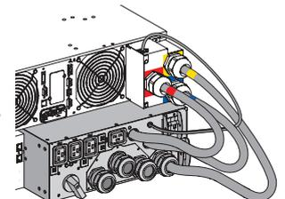
11. Drücken Sie die USV Bypass Input Ausbruchstelle der MBP Bypass I/O Abdeckung (3) heraus und setzen Sie die mitgelieferte Kabelverschraubung ein.
