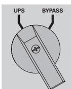
3. Setzen Sie den manuellen Bypass-Schalter am MBP auf die Stellung „**UPS**“: Die **rote Leuchte „Bypass-Modus“** am MBP verlischt und zeigt damit an, dass die Last jetzt von der USV versorgt wird
