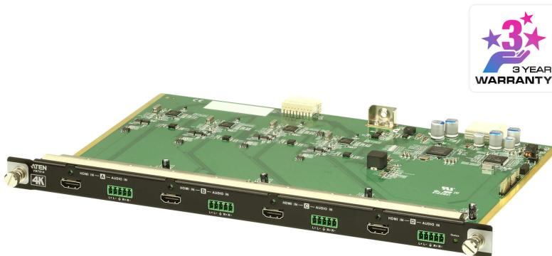
La VM7814 est une carte d'entrée HDMI 4K qui fonctionne avec un commutateur matriciel modulaire ATEN pour offrir un moyen facile de router 4 sources HDMI vers 4 affichages. En plus de l'interface HDMI qui transporte les signaux A/V numériques, la VM7814 est équipée de 4 ports d'entrée audio stéréo qui permettent l'intégration audio stéréo.
