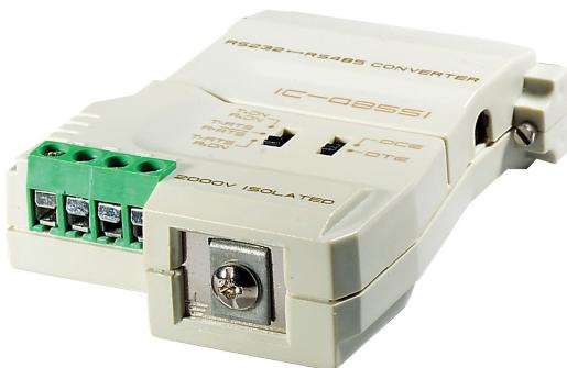
IC485SI est un convertisseur bidirectionnel pour convertir des signaux RS-232 vers et depuis des signaux RS-422/RS-485 dans des applications longue distance jusqu'à 1200 m (4000 pi). Il comprend une languette de mise à la terre pour une isolation améliorée du signal et de l'alimentation.
