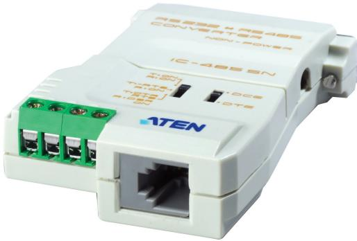
IC485SN est un convertisseur bidirectionnel pour convertir des signaux RS-232 vers et depuis des signaux RS-422/RS-485 dans des applications longue distance jusqu'à 1200 m (4000 pi) – sans avoir besoin d'une alimentation externe.
