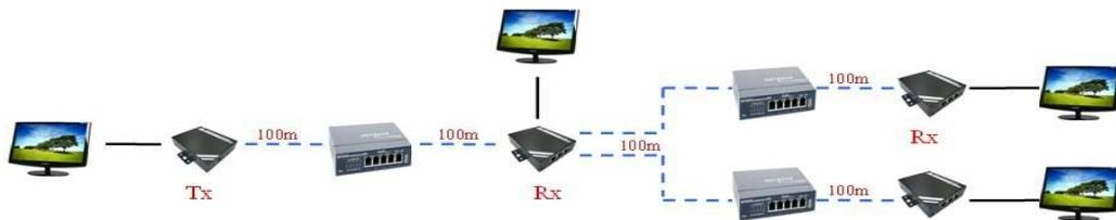
Je mehr Netzwerk-Switches vorhanden sind, desto größer ist die erweiterte Entfernung. Die Anzahl der Netzwerk-Switches ist beliebig.
