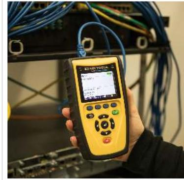
**Lokalisiert, prüft und misst Koaxial- und Datenkabel (RJ45) und erkennt Verdrahtungsfehler, Leitungsunterbrechung, Kurzschluss, Split Pairs sowie Power-over-Ethernet (PoE).**
