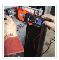
Die Zange misst den AC-Strom und das Thermoelement die Temperatur. Messleitungen zur Messung von AC/DC-Spannung, Widerstand, Durchgang, Frequenz, Kapazität und zur Diodenprüfung
