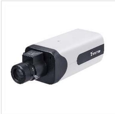
**VIVOTEKs IP9165-LPC ist eine professionelle und hocheffiziente IP-Boxkamera mit einer herausragenden Bildqualität. Bei einer Auflösung von 1080p können bis zu 60 Bilder/s erreicht werden. Durch Verwendung der H.265 Technologie ist die Kamera in der Lage effiziente Bildkompressionsraten zu erzielen. Darüber hinaus ermöglicht die VIVOTEK Smart-Stream III Technologie die Qualität in gewünschten Bereichen zu optimieren und somit die Effizienz der Bandbreitennutzung zu maximieren.**
