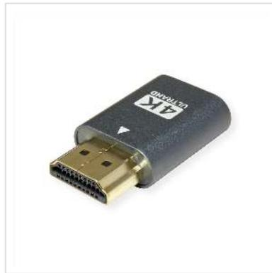
**Der EDID Emulator wird auf den Ausgang der Grafikkarte gesteckt, anstatt dass diese mit dem gewünschten Monitor verbunden ist. Dies wird von der Grafikkarte nicht bemerkt - sie behält die gewählten Einstellungen bei (Auflösung, Frequenz). Wird später wieder der Monitor angeschlossen, hat man sofort das richtige Bild. Insbesondere beim Einsatz von KVM Switchen ist dies besonders wichtig.**
