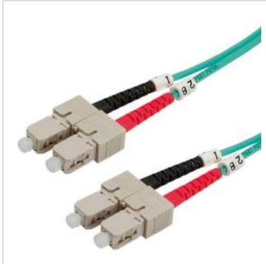
Die Verwendung von 50/125µm-Fasern in OM3-Qualität erlaubt bei hohen Übertragungsbandbreiten (ab Gigabit Ethernet) die Überbrückung größerer Distanzen. So ist bei 1000Base-SX eine Entfernung von 900m möglich - statt 550m mit "normalen" 50/125µm-Fasern (OM2). Bei 10GBase-SR ermöglicht OM3 eine Strecke von 300m gegenüber 80m bei OM2.
