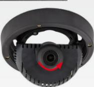
**Hinweis:** Durch den Linseneffekt der Domkuppel verändert sich der Scharfstellpunkt des Teleobjektivs B237 leicht. Drehen Sie daher das Teleobjektiv (vor Montage der Domkuppel) um ca. **90° gegen den Uhrzeigersinn** (gegen die Objektiv-Einschraubrichtung). Kontrollieren Sie die Bildscharfe
