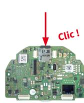
Installez la nouvelle carte MicroSD et appuyez dessus doucement avec le doigt dans le sens de la flèche, jusqu'à entendre de nouveau un **clac**.
