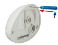
Tirez avec précaution le haut de la face arrière légèrement vers l'arrière **1**, puis dégagez la face arrière en la soulevant en arrière vers le haut **2**.
