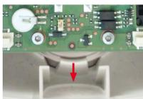
Retirez la platine principale du boîtier en exerçant une légère pression vers l'arrière sur le porte-objectif (prendre en compte l'inclinaison à 15° de la platine principale).
