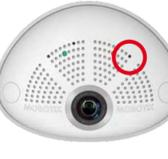
La DEL clignote une fois et répète le signal après une pause d'une seconde (la nombre des clignotements correspond à l'option de démarrage actuelle). Pressez brièvement avec le trombone (< 1 sec.) afin de basculer vers l'option de démarrage prochaine. Après la dernière option de démarrage dans le menu, la caméra recommencera avec la première option (un clignotement).
