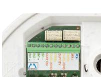
Lors du branchement des câbles de connexion au MxIOBoard-IC, veillez à les raccorder à la platine sans traction (si besoin, déchargez la traction en posant un attache-câbles sur le câble réseau).
