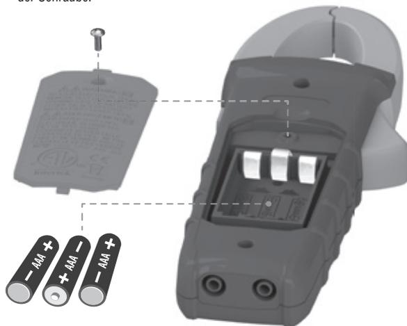
**⚠ Trennen Sie die Leitungen von allen potenziellen Spannungsquellen, bevor Sie die Batterieabdeckung öffnen, um eine Stromschlaggefahr zu vermeiden.**
