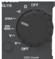
⚠ **Entfernen Sie zum Messen mit der Zange die Messleitungen vom Messgerät.**
